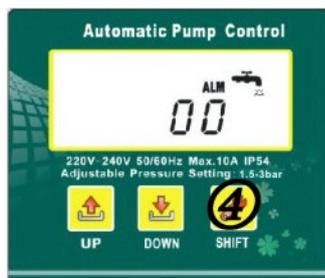
**Anhalten bei Trockenlauf:** Das Anhalten bei Trockenlauf wird auf dem LCD Display bei abgeschaltetem Motor gemeldet. Zur Rückstellung der Anlage genügt es, die Taste SHIFT (4) zu drücken, nachdem sichergestellt wurde, dass Wasser in der Ansaugung vorhanden ist.
