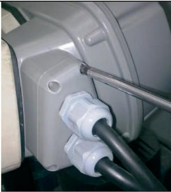
Den seitlichen Kabeldurchführungs-Deckel öffnen (4 Schrauben).
