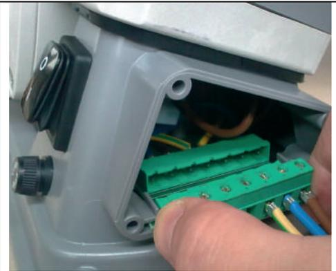
Den Verbinder einsetzen und den Kabeldurchführungs-Deckel schließen.
