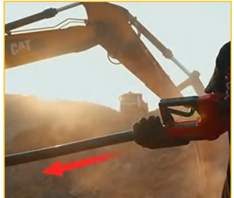
Schritt 5: Zum Einziehen der Rolle nach der Betankung den Schlauch halten, leicht herausziehen und dann langsam zurückführen.
