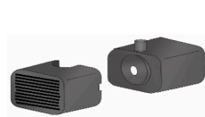
Laufradgehäuse öffnen, das Laufrad entnehmen
