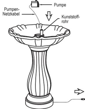
5.3 Platzieren Sie die obere Wasserschale auf der Säule. Drehen Sie die Schale im Uhrzeigersinn, um sie mit der Säule fest zu verbinden..
