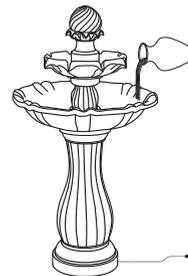
5.4 Platzieren Sie die obere Säule in der oberen Wasserschale. Drehen Sie die Säule im Uhrzeigersinn, um sie mit der Schale fest zu verbinden.
