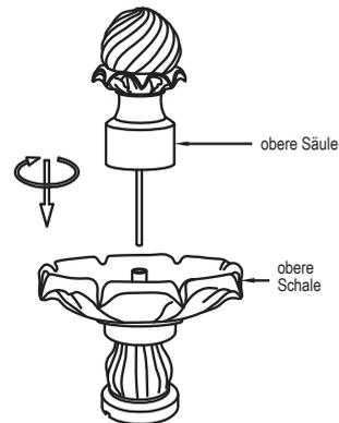
5.5 Verbinden Sie die Pumpe mit dem Gummischlauch. Platzieren Sie das obere Brunnengehäuse in der Wasserschale. Drehen Sie die Figur im Uhrzeigersinn, um sie mit der Schale fest zu verbinden.
