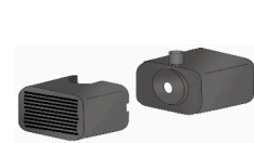
Laufradgehäuse öffnen, das Laufrad entnehmen
