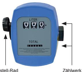
Die obere Ziffer zeigt die aktuelle Füllmenge an und die untere Ziffer die Gesamtmenge. Mit dem Rückstellknopf kann nur das obere Zählwerk auf Null gestellt werden. Die Anzeige der Gesamtfüllmenge kann nicht zurückgestellt werden.
