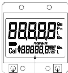
RESET-Taste LCD Display CAL-Taste
