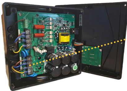
Power supply and main board / Netzteil und Hauptplatine
